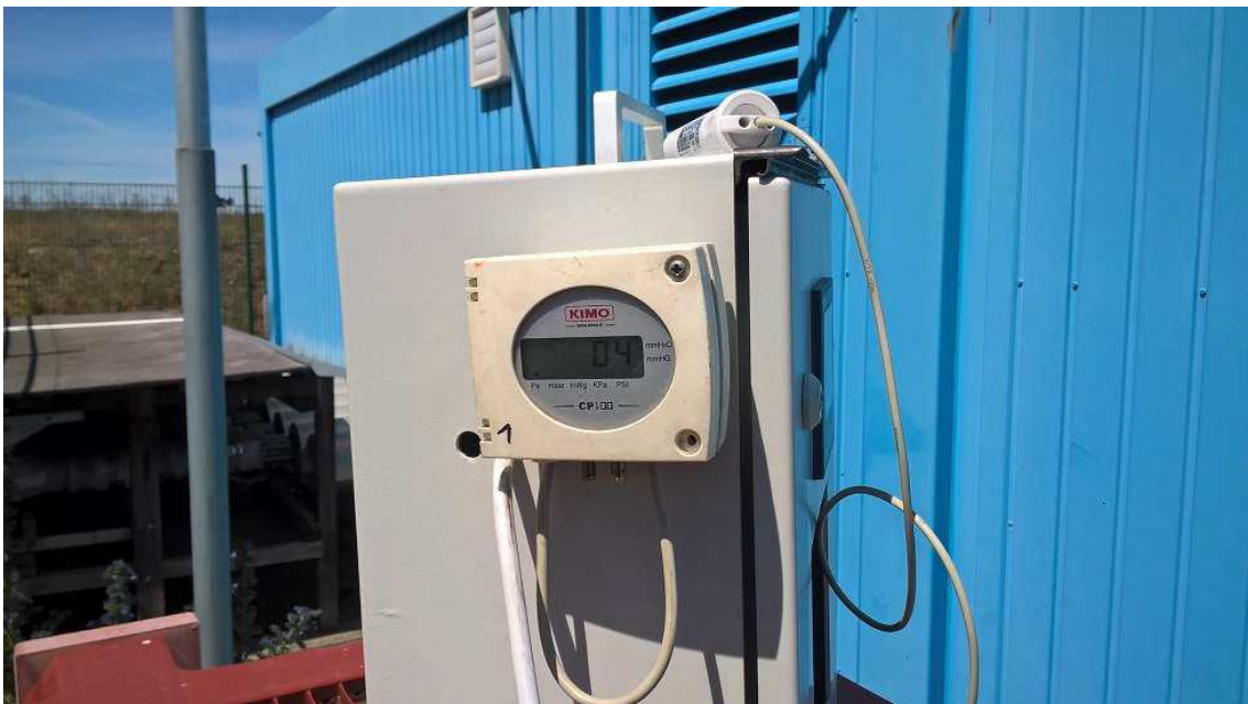
Abbildung 12: Geber Normsignal mit Differenzdrucksensor
