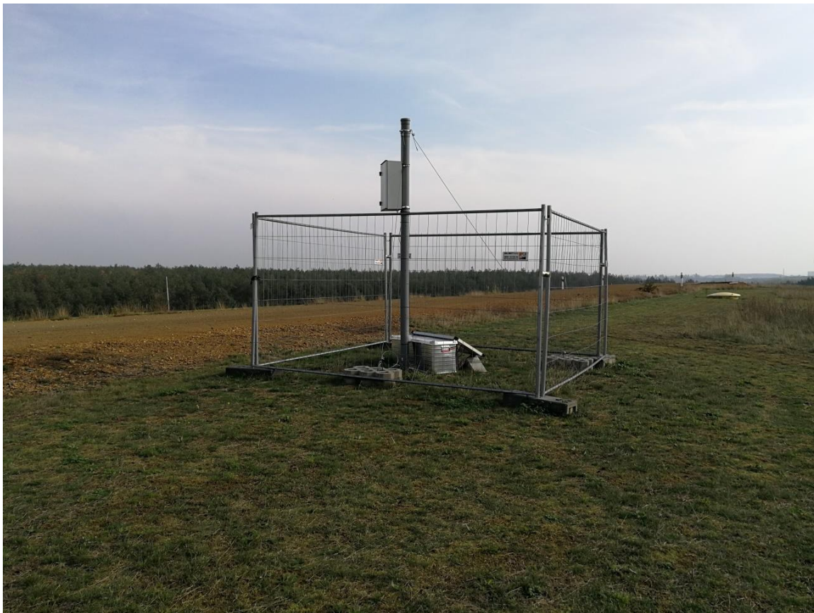
Abbildung 14: Temporärer Sendemessmast auf der Deponie, Messanlage durch Bauzaun gesichert
